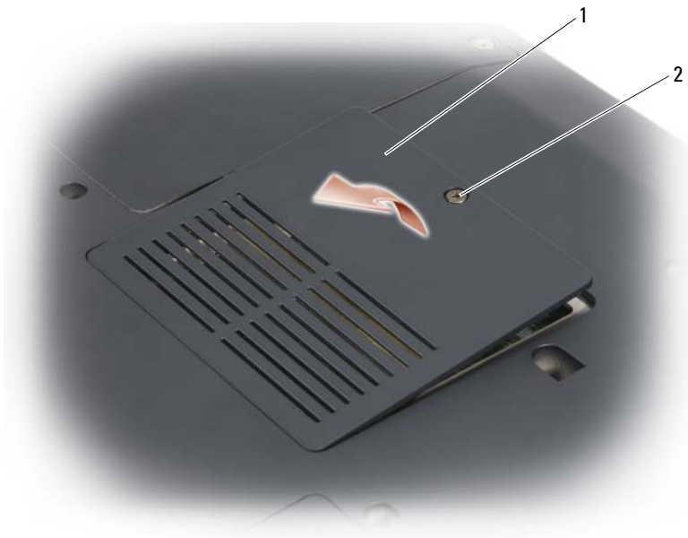
1 memóriamodul/gombelem fedél 2 rögzítőcsavar
